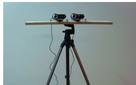
Figura 6: sistema de captura de imagens em estéreo.
